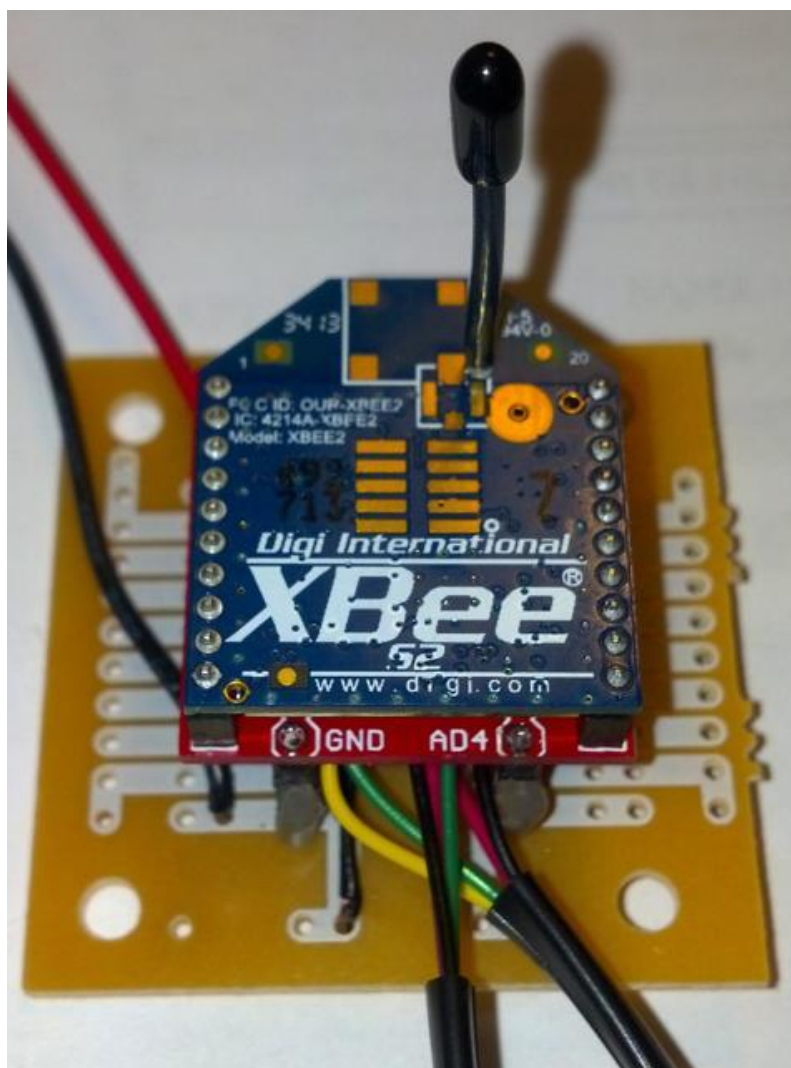
Рисунок 11. Узел сети с XBee
